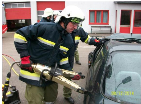
An einem ausgedienten Fahrzeug wurde mit dem hydraulischen Rettungssatz geübt den Fahrgastraum frei zu bekommen. Eine leistungsstarke Schere dient dazu die Karosserie aufzuschneiden, mit Hilfe eines Spreizers werden eingedrückte Fahrzeugteile auseinandergelassen, um z.B. eingeklemmte Personen zu befreien.
