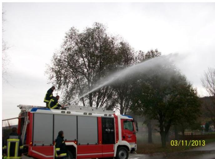
Ebenfalls zu erwähnen ist der Wasserwerfer, welcher am Dach montiert ist, und bis zu 2.400 Liter Wasserdurchfluss pro Minute erbringen kann.
